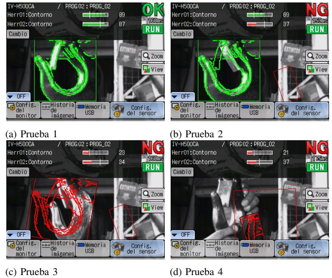
Fig. 8. Pruebas del seguro (a) Gancho y seguro no detectado. (b) Seguro no detectado. (c) Gancho y seguro no detectado. (d) Posición errónea del gancho.
