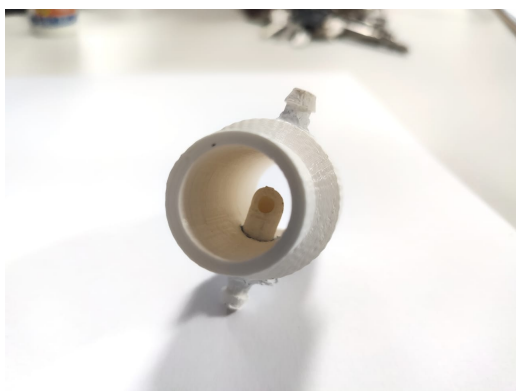
Fig. 3. Sensor de volume real com tubo de pitot para medição de fluxo (vista frontal).
