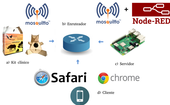
Fig. 5. Diseño de prueba del sistema Rinku. a) Kit Clínico, b) Enrutador, c) Servidor MQTT Mosquitto y Node-Red en Raspberry pi, d) Dispositivo final puede hacer una petición https Request mediante Safari o Chrome a la plataforma web diseñada en Node-Red.
