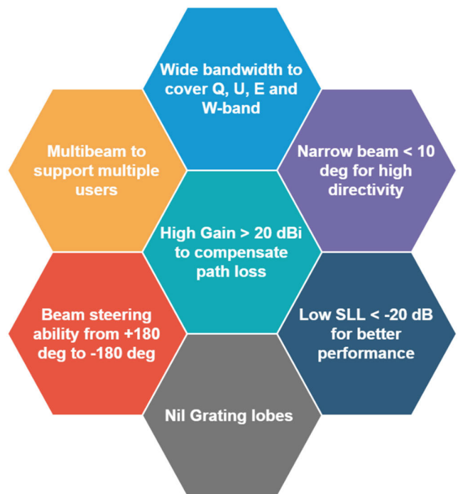
FIGURE 1. Parameter standards for array antenna.
