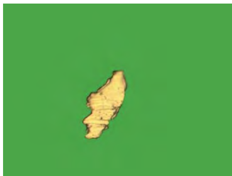
(d) Severe sliding debris
