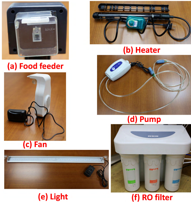
FIGURE 4. The FishTalk actuators (RO: Reverse Osmosis). (a) Food feeder. (d) Heater. (c) Fan. (d) Pump. (e) Light. (f) RO filter.
