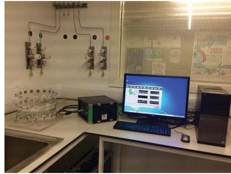
Fig. 7. Experimental EIT measurement system.
