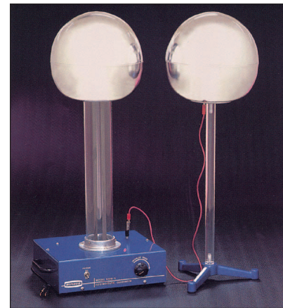
An example of the mini Van de Graaff generator.
